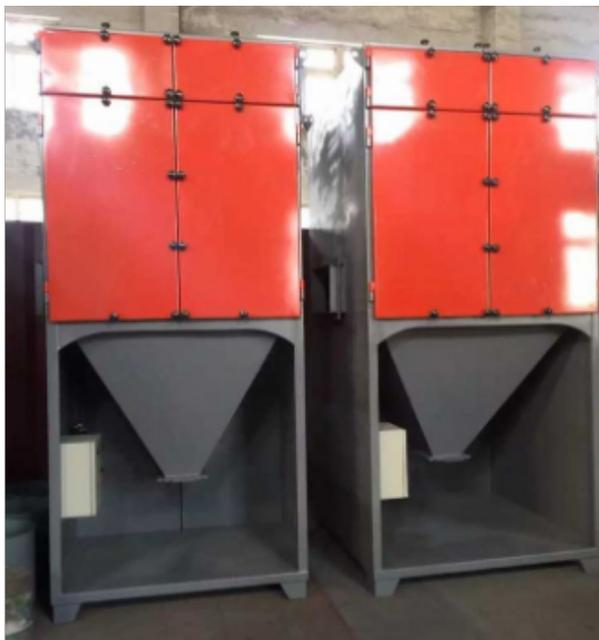
袋式除尘器的应用已有百余年的历史，其比较大的优点是除尘效率高（达99.99%以上），排放浓度可达到 $10\text{mg}/\text{m}^3$ 以下，且分级效率也很高，对 $2.5\mu\text{m}$ 以下的微细颗粒物也有很好的捕集效率，因此得到的应用。但袋式除尘器经过多年的运行也暴露出一些问题，如滤袋易损坏、结露、运行阻力高、清灰失灵、灰斗卸灰不畅等。造成袋式除尘器运行出现问题的因素有很多，除了除尘器自身因素外，操作、管理不当也是造成其在运行中出现问题的主要原因。本文对目前袋式除尘器在运行过程中经常出现的问题进行了分析讨论。除尘器主要由上箱体、中箱体、灰斗、进风均流管、支架滤袋及喷吹装置、卸灰装置等组成。[长安区简单除尘设备价格](#)
