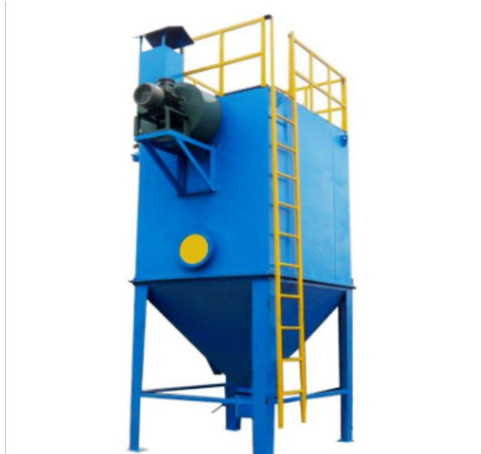
除尘器，布袋式除尘器，袋式除尘器产品简介：低压脉冲喷吹长袋除尘器是在总结各种袋式除尘器的基础上发展起来的一种新型、高效袋式除尘器。它采用离线低压脉冲喷吹清灰技术，防止了粉尘再附与失控问题，增强了滤袋的清灰效果，提高了过滤速度，节省清灰能耗和延长滤袋的寿命。除尘器采用PLC可编程序控制器，自动控制清灰、输灰的全过程。因此，该除尘器是一种处理风量
