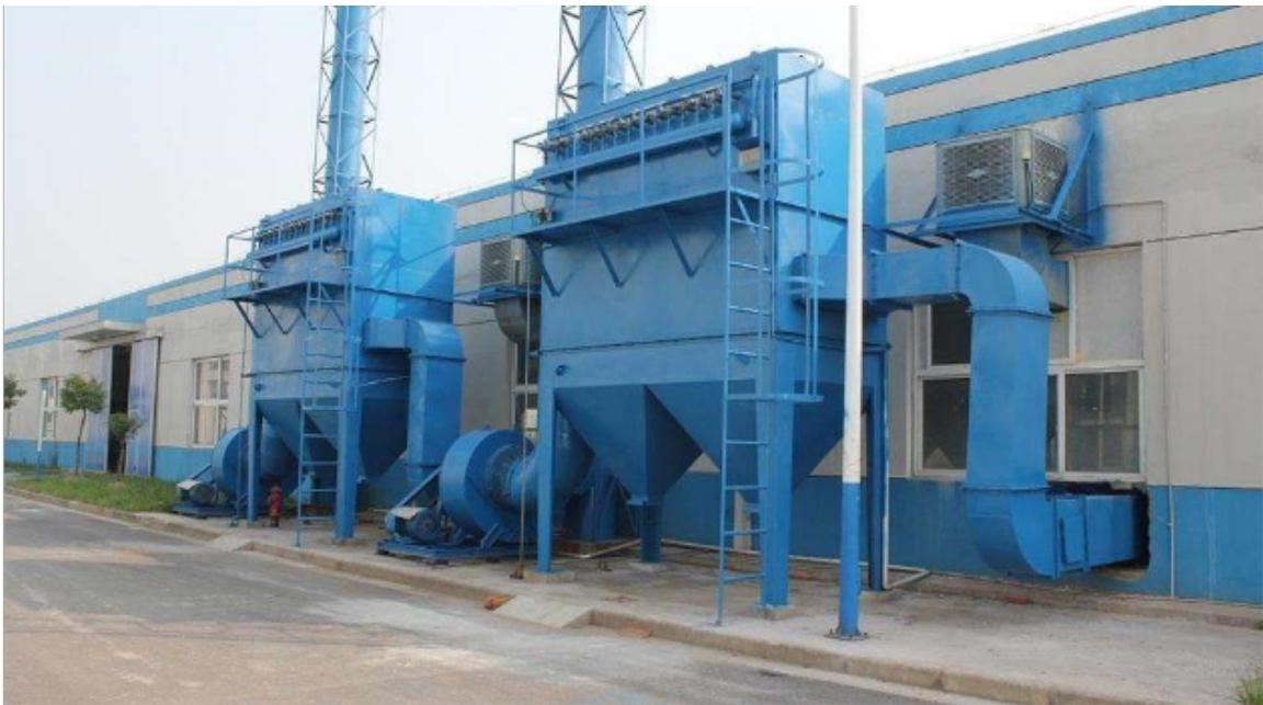
干式机械除尘器，主要指应用粉尘惯性作用、重力作用而设计的除尘设备，如沉降室、惰性除尘器、旋风除尘器等高浓度的除尘器等，主要针对高浓度粗颗粒径粉尘的分离或浓集而采用。湿式除尘器依靠水力亲润来分离、捕集粉尘颗粒的除尘装置，如喷淋塔、洗涤器、冲击式除尘器、文氏管等，在处理生产过程中发生的高浓度、大风量的含尘气体场合采用较多。对较粗的，亲水性粉尘的分离效率比干式机械除尘器要高。箱体采用气密性设计，密封性好，检查门用优良的密封材料，制作过程中以煤油检漏，漏风率很低。高陵区小型除尘设备多少钱除尘器，布袋式除尘器，袋式除尘器。
